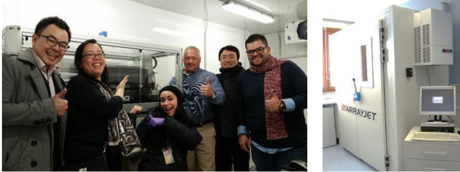
图1： Ultra Marathon II 在美国巴尔的摩安装后，客户对仪器非常满意（左边）。 Ultra Marathon II 加上Jetmax 环境控制系统，实现在极低的温度下进行点样（右边）。
